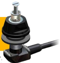
La M8 es la base de montaje en panel "estándar de la industria". Incorpora contacto de puesta a tierra de acero inoxidable y una construcción totalmente moldeada con cable coaxial de alta calidad para una baja pérdida y fiabilidad a largo plazo. La versión M8A es adecuada para la aplicación de paneles gruesos.
